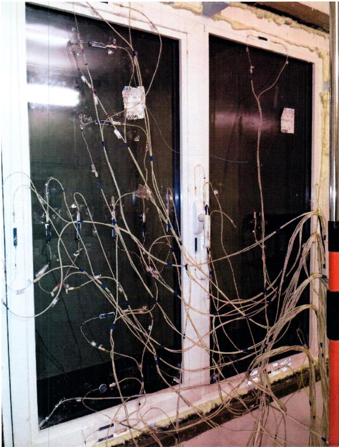
Рис.3. Внешний вид образца, установленного в климатической камере КТК-2007
