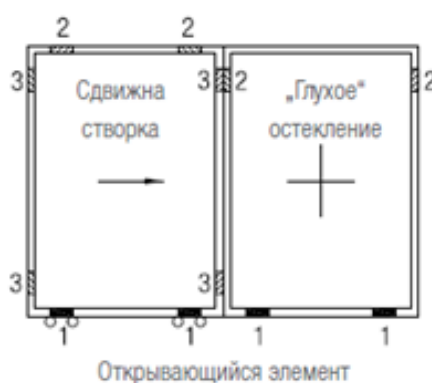
Рис. 9. Схема расположения подкладок при монтаже сп.
