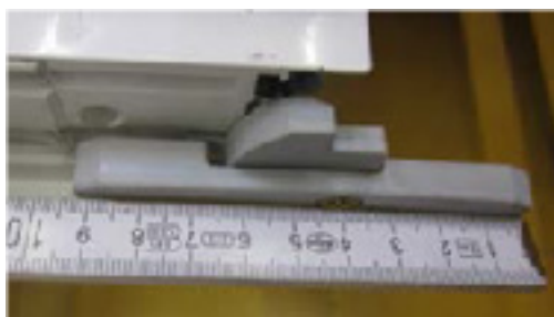
Рис. 2. Опорная площадка и угловая опора с поворотной планкой
