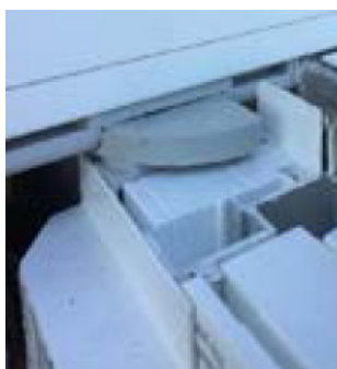
Рис. 9. Величина зазора между угловой опорой и посадочной планкой
